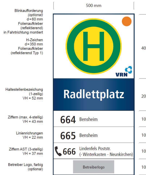
Vorlage 3: Wechselschildsystem mit gewölbter Oberfläche (höherwertiges System)
